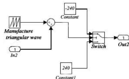
Figure6: PWM wave generator
